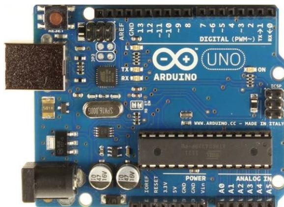
Figura 3 – Placa de desenvolvimento Arduino. Fonte: Núcleo NETI
