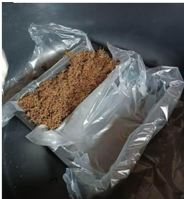
Figura 5 – Moldagem dos tijolos em micélio
