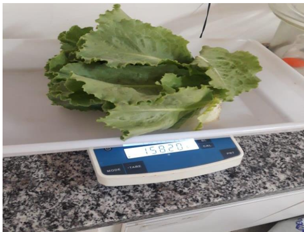
Figura 3: Obtenção dos valores de massa fresca ( g.planta^{-1} ) com auxílio de uma balança analítica. Fonte: Autoria própria, 2020.
