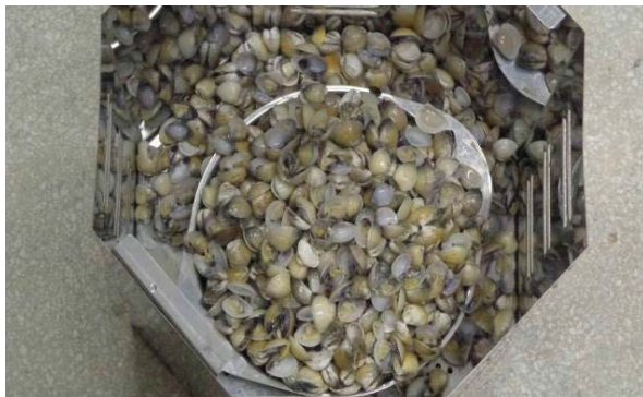
Figura 16 – Mariscos abertos após a operação de cocção e abertura em autoclave
