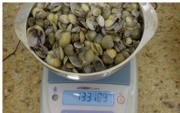
Figura 21 — Pesagem das conchas após a separação no protótipo da máquina rotativa
