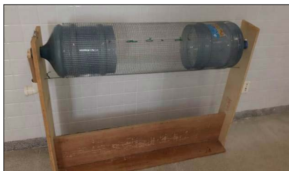
Figura 11 – Protótipo com estrutura em madeira e tambor giratório plástico, com peneira em malha galvanizada quadrática 11 x 11 mm 2
