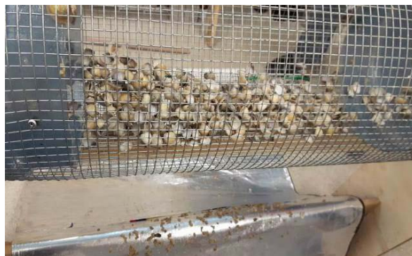
Figura 18 – Separação das conchas e carnes dos mariscos na máquina rotativa
