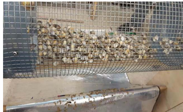
Figura 18 – Separação das conchas e carnes dos mariscos na máquina rotativa
