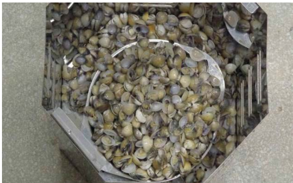
Figura 16 – Mariscos abertos após a operação de cocção e abertura em autoclave
