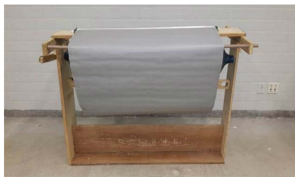
Figura 13 – Protótipo de máquina de separação de mariscos, usando-se materiais alternativos e recicláveis
