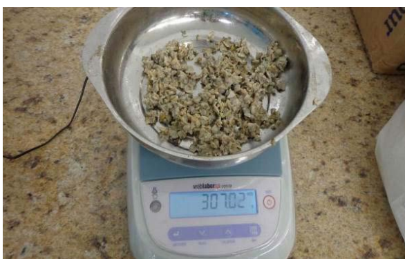
Figura 20 — Pesagem da carne dos mariscos após a separação no protótipo da máquina rotativa
