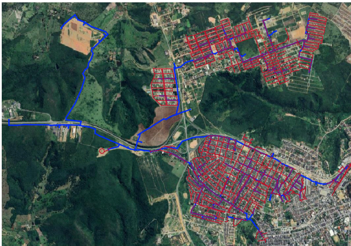
Figura 11 – Topologia do alimentador da Neoenergia Pernambuco utilizado no estudo de caso
