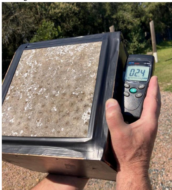
Figura 4 – Ensaio de transmitância luminosa
