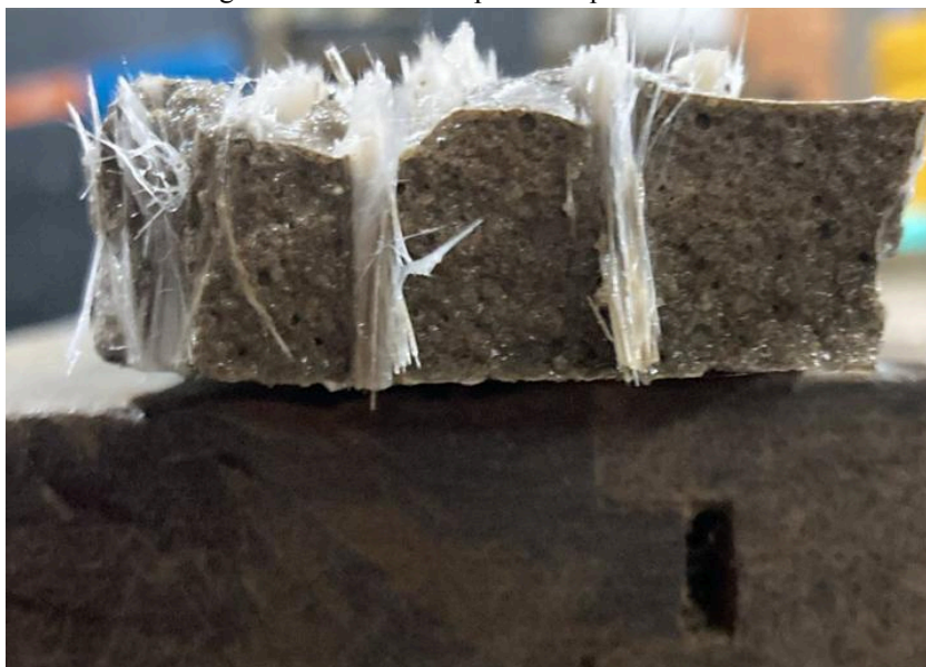
Figura 6 – Pontos de ruptura das placas
