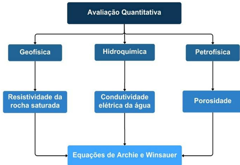
Figura 3 – Fluxograma dos métodos integrados para estimativa de reserva de água subterrânea na FSM
