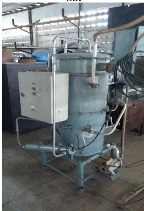
Figura 1 – Protótipo do sistema de refrigeração por absorção de vapor de duplo em série com disposição em torre
