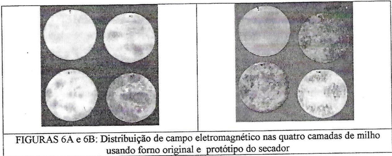
Comparando-se as figuras, pode-se observar que a distribuição de campo eletromagnético é mais uniforme para o caso do protótipo, em virtude da utilização do espalhador de campo eletromagnético.
