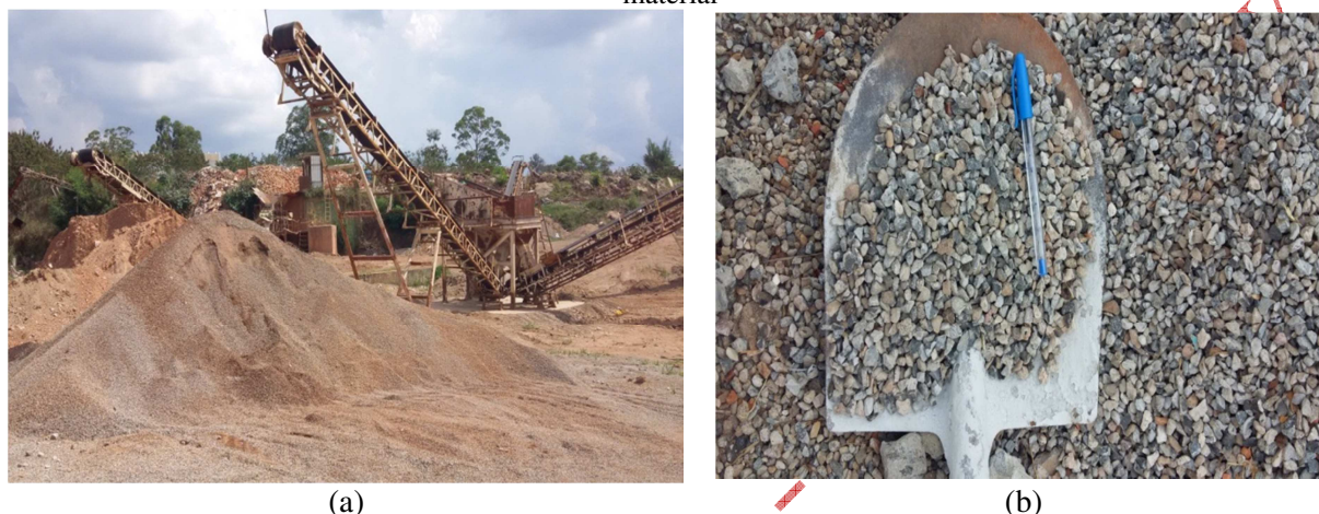
Figura 1 – Lote para coleta dos agregados graúdos reciclados (a) pilha de agregados reciclados; (b) detalhe do material
