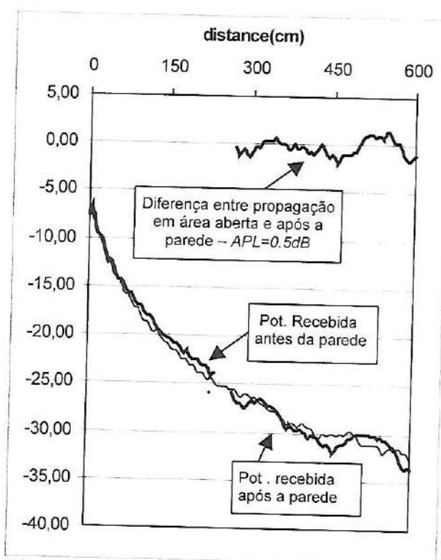
Fig.6. Parede de "eucatex" - Potência recebida (dBm) x distância (cm)
