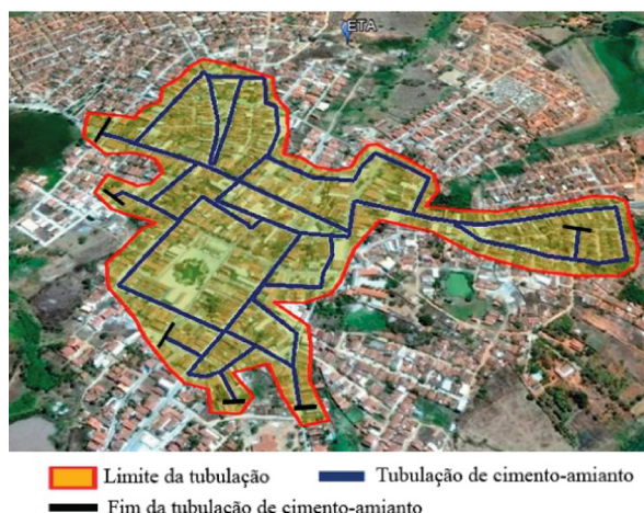
Figura 6. Mapeamento digital da tubulação em estudo.
