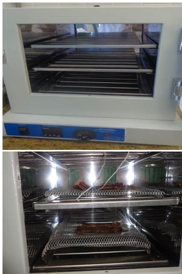
Figura 4 - Diagrama esquemático e montagem real do secador convectivo alternativo
