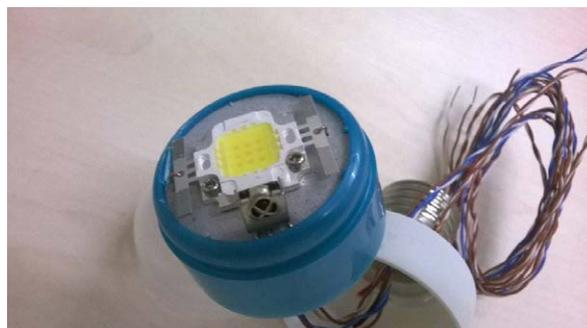
Na Figura 11 é apresentado o protótipo do módulo externo à lâmpada, cuja finalidade é captar a iluminância externa – por meio de um sensor LDR fixado na face voltada para a fonte de luz natural – e enviar as informações pelo transmissor infravermelho localizado no lado oposto.
