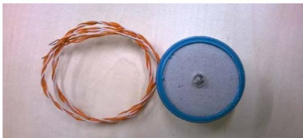
Na Figura 12 está apresentada a face do módulo que seria adesivada a uma janela – destaque para o sensor LDR entre as espumas.
