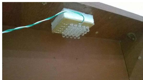
Para posicionar o luxímetro, considerou-se que a intensidade luminosa é máxima no centro da fonte de iluminação, decaindo gradativamente à medida que se distancia do centro. Portanto, é importante garantir que o centro da iluminação esteja perpendicular ao sensor do luxímetro.
