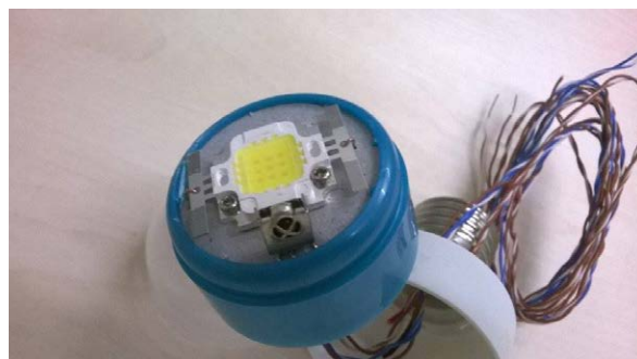
Figura 10 – Detalhe do receptor infravermelho e do LED de alta potência.
