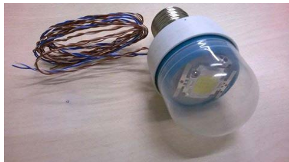
Figura 10 – Detalhe do receptor infravermelho e do LED de alta potência.
