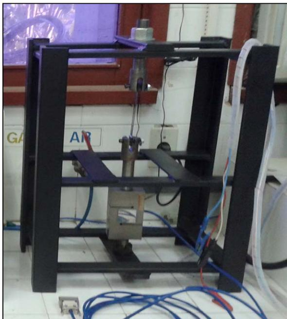
Figura 5 – Imagem mostrando o corpo de prova e a célula de carga (região inferior da Figura).
