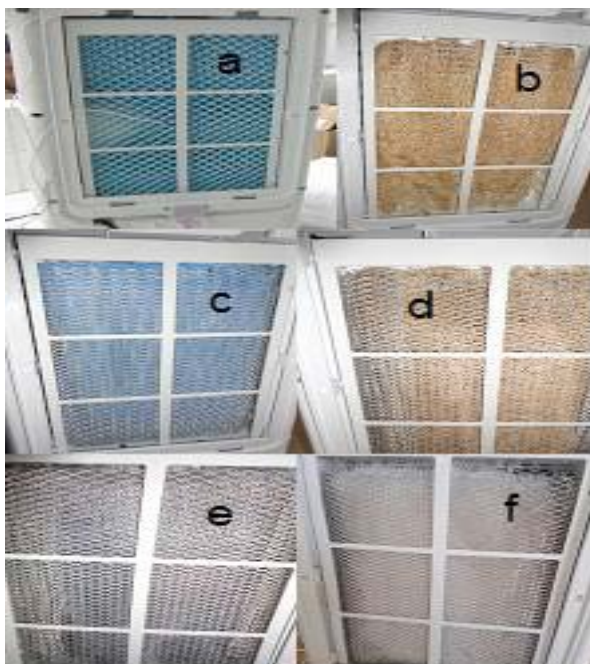
Figura 6 – Painéis evaporativos: comercial, fibra vegetal, malha metálica, malha sintética
