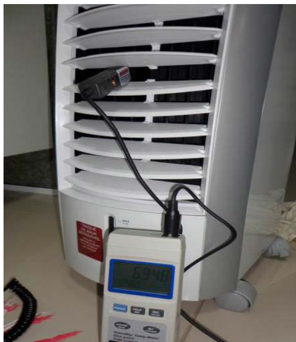
Figura 8 – Termo-higrômetro utilizado para verificar o efeito evaporativo no climatizador
