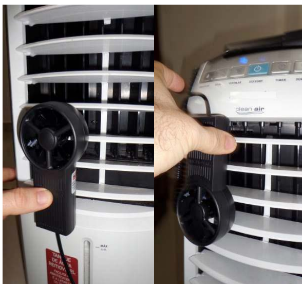
Figura 7 – Medição de velocidade de saída do ar do climatizador.
