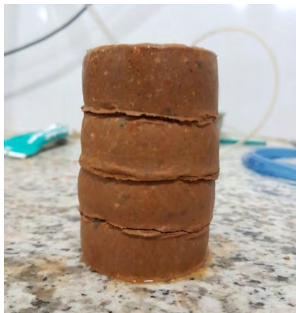
Figura 3 – Aspecto do corpo de prova reforçado após ensaio triaxial
