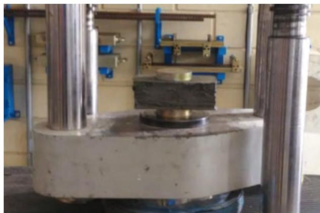
De acordo com a NBR 9781 (ABNT, 2013), a resistência à compressão é obtida através da divisão da carga de ruptura pela área de carregamento, multiplicando-se esse valor por um fator “p” em função da altura da peça, conforme a Tabela 2.
