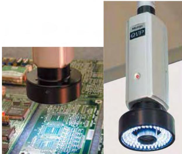
A iluminação do tipo LED permite baixíssimo consumo de energia, abaixo de 10 W de potência. Como um todo, o QVP chega a dissipar apenas 45 W de energia. Tal sensor permite ainda a permutação de lentes de diferentes ampliações.
