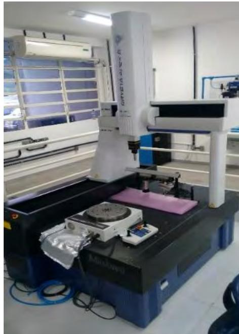
A MMC é constituída basicamente de eixos coordenados cujos deslocamentos são controlados via código numérico computadorizado (CNC), mesa metrológica ou desempenho em granito e sensores para medição. A Crysta-Apex S 7106 consiste em uma MMC multissensor, apresentando sensor de contato e sensores para medição sem a necessidade de contato sensor-peça. O sensor de contato é do tipo apalpador de
