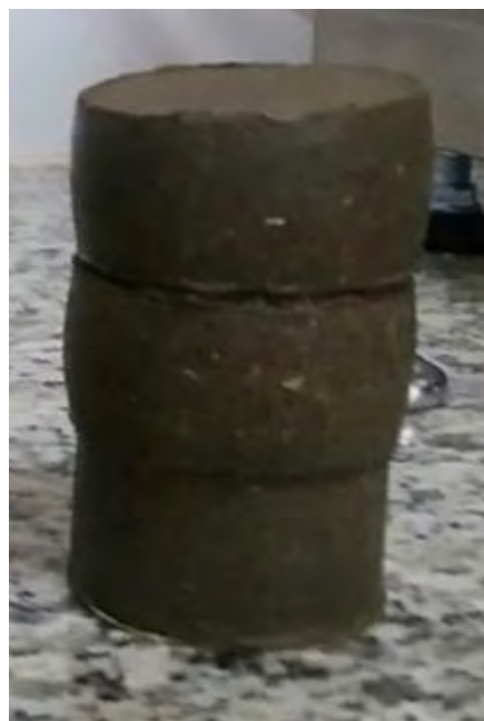
Figura 10 – Solo reforçado com geotêxtil após realização do ensaio triaxial
