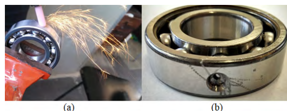
Figura 1 – Falha na pista externa do rolamento
