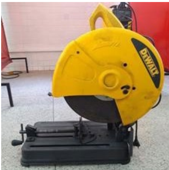
Figura 4 – Policorte modelo DeWALT D28720-B2.
