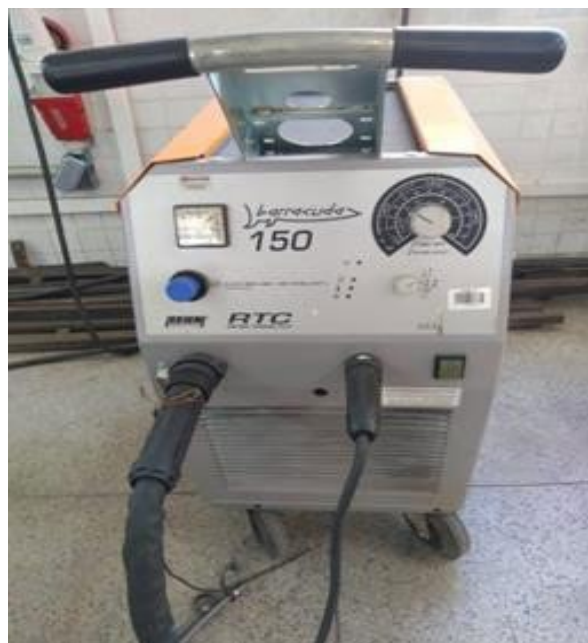
Figura 3 – Máquina de corte a plasma Barracuda 150 da RHEM Welding Technology
