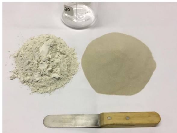
Figura 2 – Etapa de adição de Cal Virgem (CaO) nas amostras.
