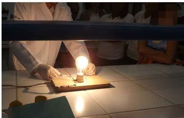
Figura 3 - Carbono grafite conduzindo eletricidade
