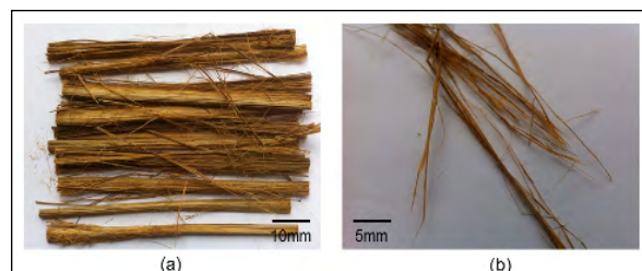
Figura 7 – Aparência das fibras após o tratamento químico, (a) individualização, (b) detalhe dos fios
