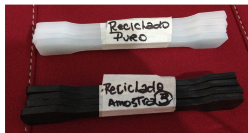
Figura 1 - Fotografia dos corpos de prova do PEAD reciclado sem carga e do PEAD reciclado com carga.
