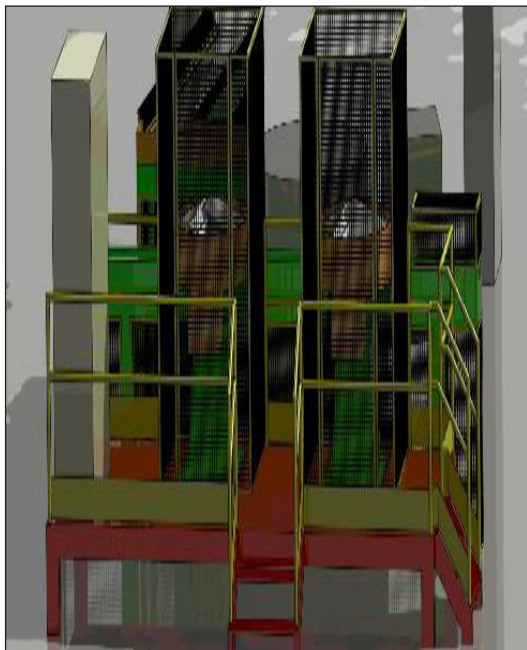
Figura 3 – Vista isométrica da cilindradeira com proteções
