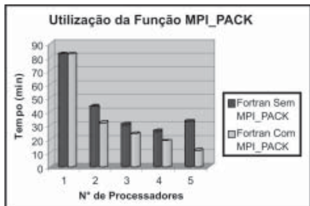
Figura 9. Tempos da Linguagem Fortran Utilizando e não-Utilizando a Função MPI_PACK.
