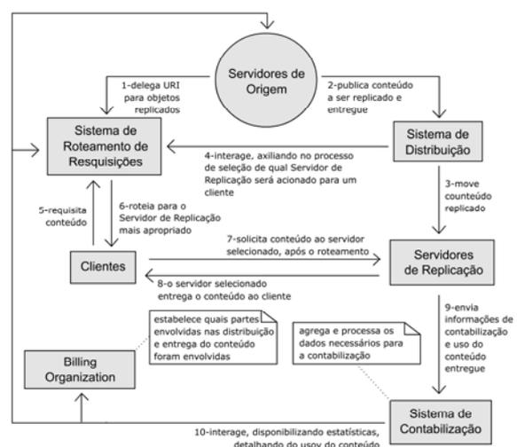
**Fig. 2 -Arquitetura básica de uma CDN. Adaptação [10].**
