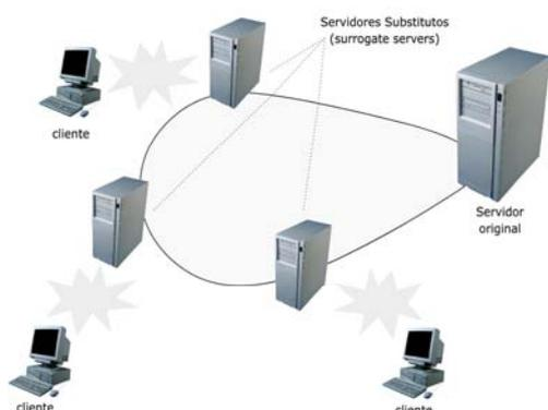
**Fig. 3: Distribuição dos Servidores Substitutos numa RDC. Adaptação [14].**
