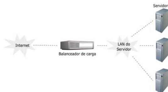
**Fig. 3: Balanceamento da carga no front-end [14].**
