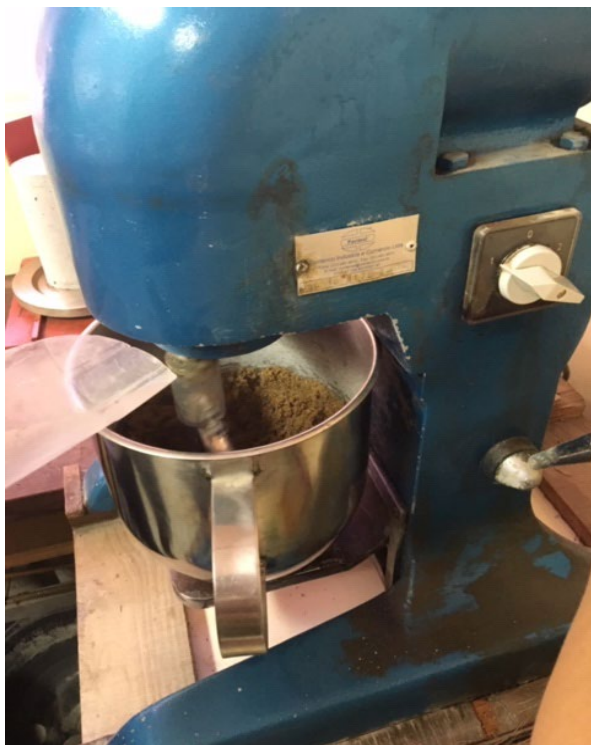
Figura 4 – Preparação da argamassa
