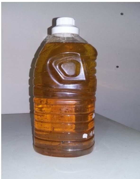
Figura 1 – Óleo recolhido com presença de impurezas
