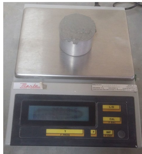
Figura 6 – Ensaio de densidade da argamassa no estado fresco
