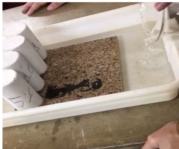
Figura 9 – Ensaio de absorção de água por capilaridade
