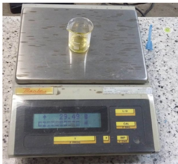
Figura 2 – Ensaio de densidade do óleo
