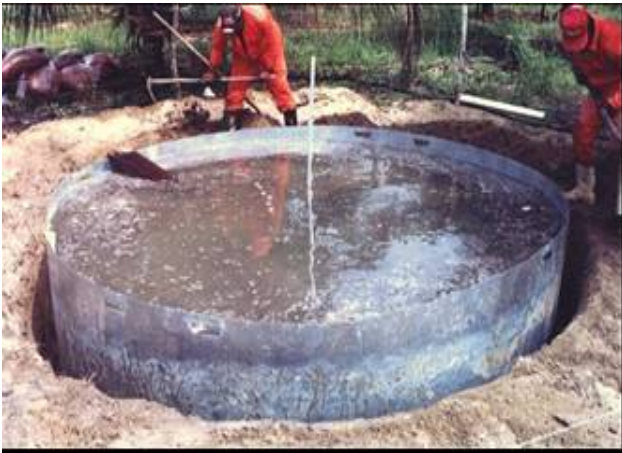
Figura 1 - Inundação do dique até a saturação total do perfil do solo
