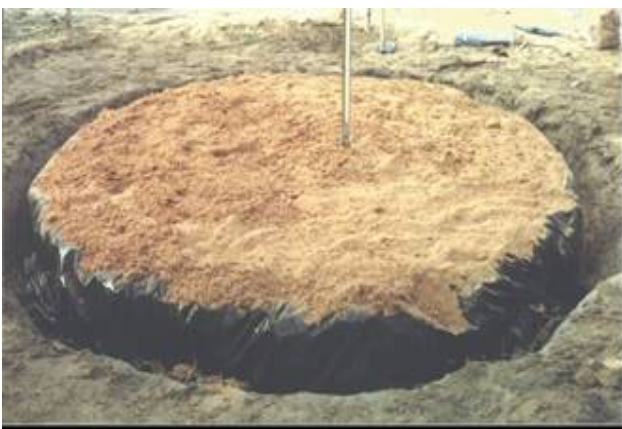
Figura 2 - Detalhe do pó de serra colocado para isolamento térmico sobre uma lamina de plástico preto e instalação de tensiômetros.
