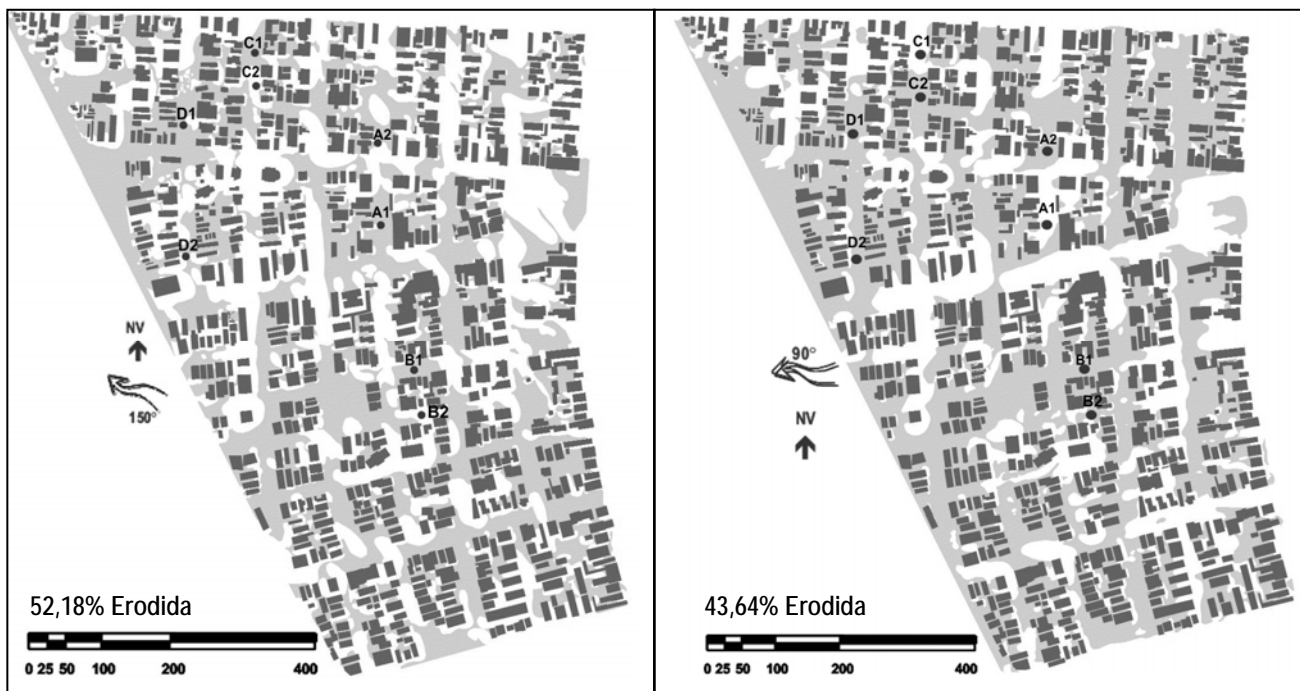
Figura 7. Comparação entre as figuras de erosão para as direções de vento 150° e 90° a 330rpm.
