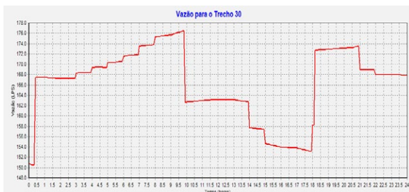
Figura 6 – Operação das bombas no R-05 (CMB-01)
