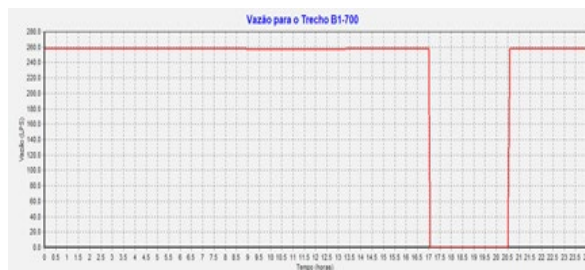
Figura 9 – Operação das bombas em Gravatá (B1-700)
