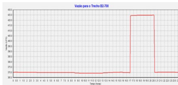
Figura 10 – Operação das bombas em Gravatá (B2-700)
