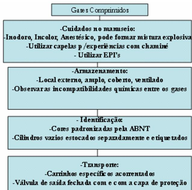
**Figura 16 – Proposição para o gerenciamento dos gases comprimidos.**
