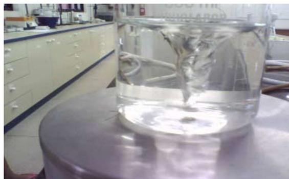
**Figura 6.** Barra magnética alternativa em uso sobre um agitador magnético.
