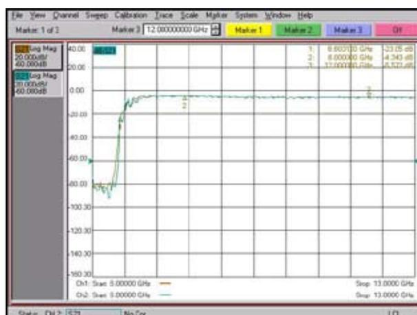
**Fig. 11 – Comparação do desempenho do guia de onda – Ch1: Guia importado, Ch2: Guia em alumínio**
