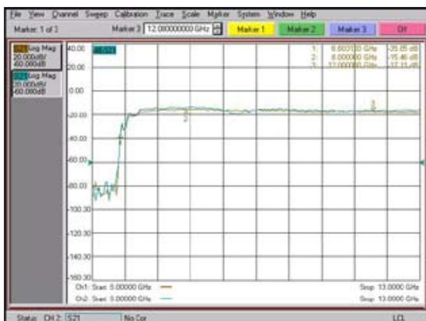
**Fig. 9 – Comparação do desempenho da antena – Ch1: Antena importada, Ch2: Antena em alumínio**
