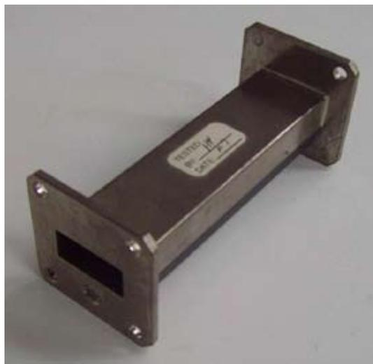
Fig. 1 – Guia de ondas comercial importado
