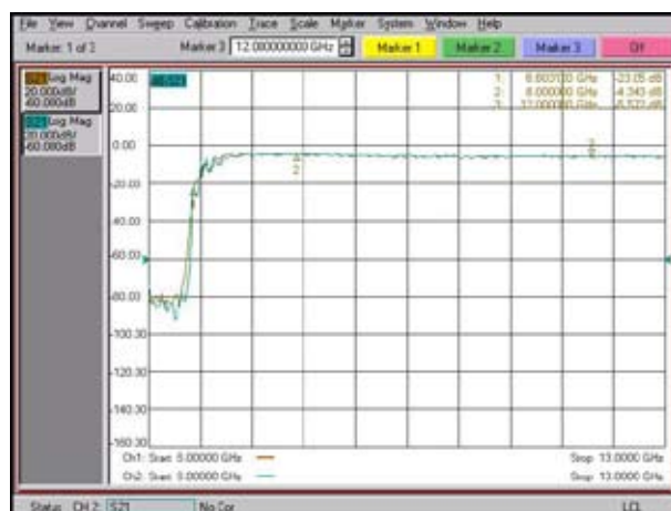
Fig. 11 – Comparação do desempenho do guia de onda – Ch1: Guia importado, Ch2: Guia em alumínio
