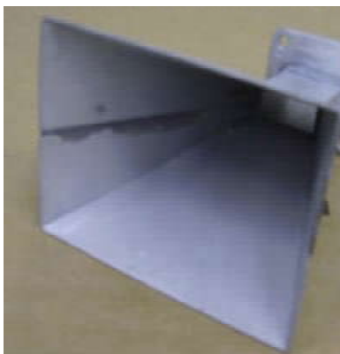
Fig. 7 – Antena corneta em alumínio utilizando adesivo epóxi
