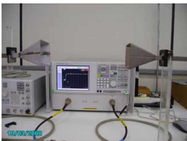
Fig. 8 – Verificação do desempenho da antena - Resultado equivalente ao comercial
