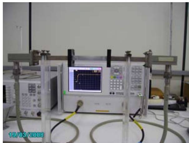
Fig. 10 – Verificação do desempenho do guia de onda - Resultado equivalente ao comercial
