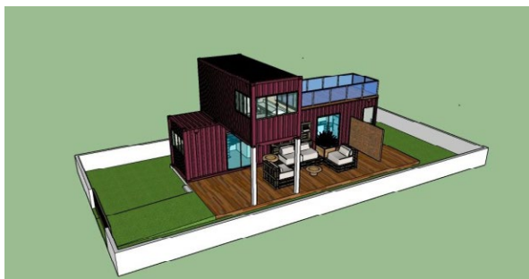
Figura 17 – Disposição dos containers
