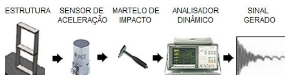
Figura 7 – Esquema de instrumentação e captação dos sinais gerados em vibração livre
