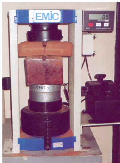
Figura 1 (A) Esquema do ensaio de resistência a tração e (B) Realização do ensaio.
