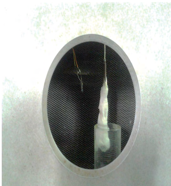
Figura 4. Sensores instalados na saída do túnel.
