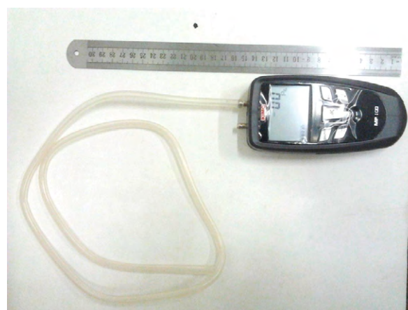
Figura 3. Sensor de pressão piezelétrico de modelo (Kimo MP 100).
