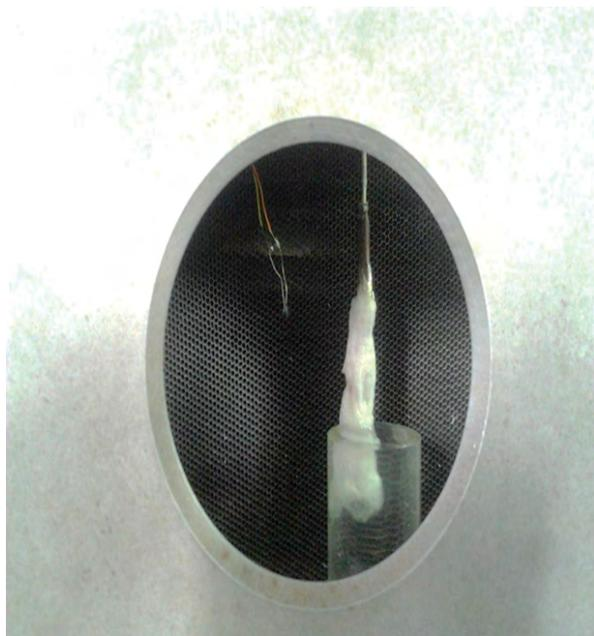
Figura 4. Sensores instalados na saída do túnel.
