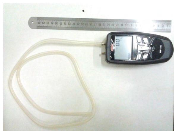
Figura 3. Sensor de pressão piezelétrico de modelo (Kimo MP 100).
