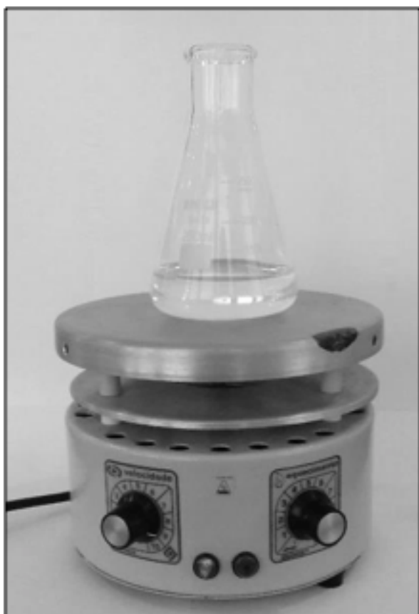
Figura 2 - Erlenmeyer de 250 mL contendo 100 mL de água mineral aquecendo em chapa aquecedora
