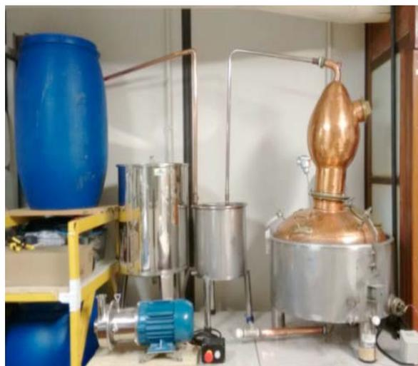
Atualmente a planta é composta por um equipamento de refrigeração conectado a quatro tanques para armazenamento de água para arrefecimento dos processos; três dornas de fermentação em aço inox (biorreatores encamisados). Sensores de temperatura e de vazão estão distribuídos nos elementos que compõem o processo de destilação e fermentação. Detalhes podem ser vistos nas Figuras 3 e 4.
