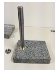
Figura 4 – (a) Vista superior da montagem. (b) Foto da bucha de bronze usinada. (c) Vista inferior da Montagem.
